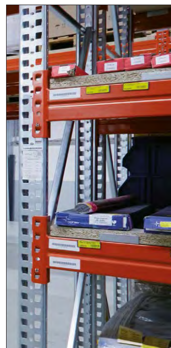
Traverse fixate cu siguranțe
